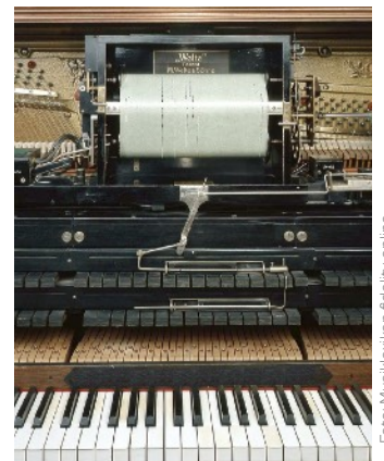
Eine Welte-Mignon-Mechanik reproduziert die individuelle Pianistik längst verstorbener Komponisten
